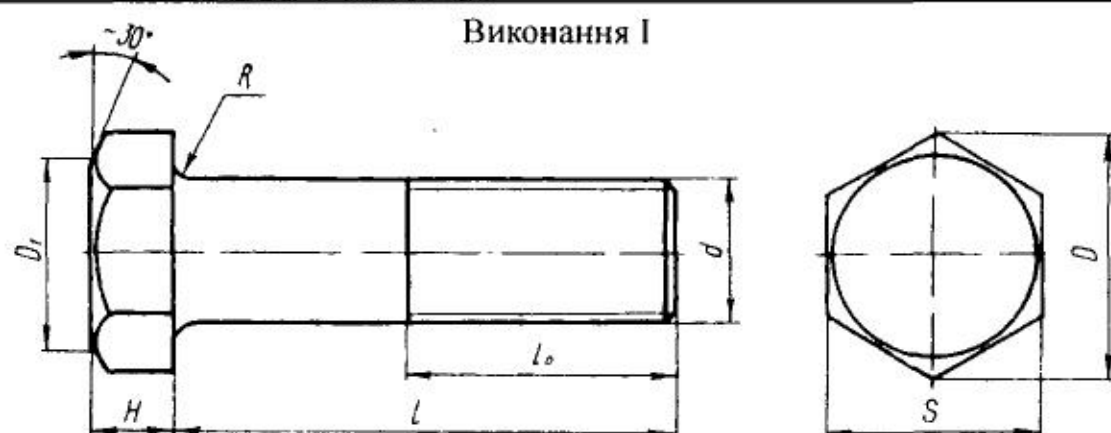
Таблиця 11.4 Болти з шестигранною головкою нормальної точності
