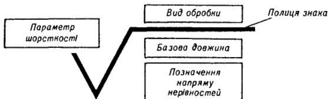
Рис.9.16. Структура повного позначення шорсткості поверхні на кресленні.
